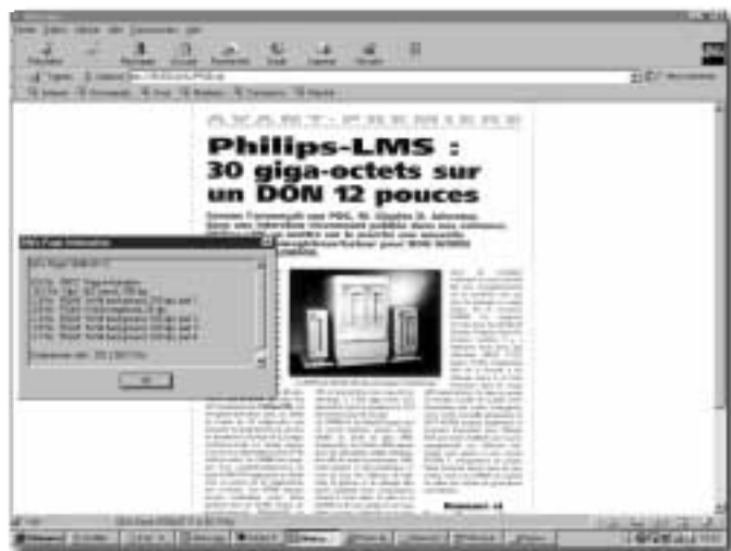
Exemple de document A4 numérisé en noir et blanc sur 256 niveaux de gris à 300 DPI compressé avec DjVu. Le fichier original est de 5,8 méga-octets, une fois traité avec DjVu, il ne pèse que 51 kilo-octets tout en préservant la restitution des photographies et du texte.
