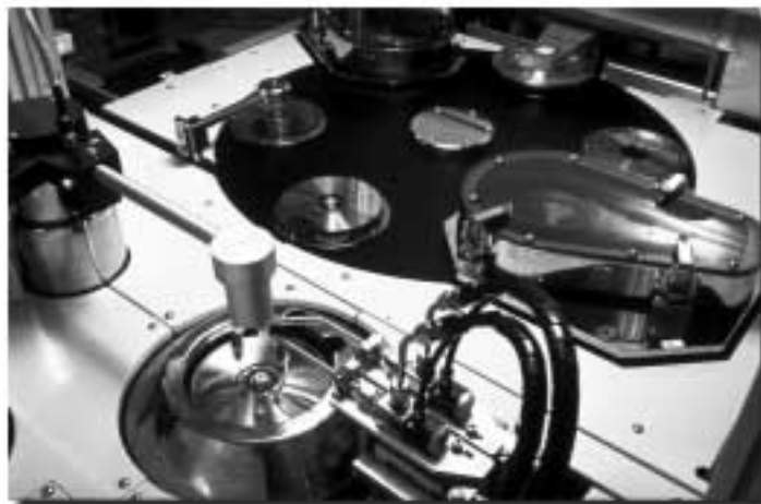
Phase de métallisation et de vernissage des CD-R chez Mitsui
