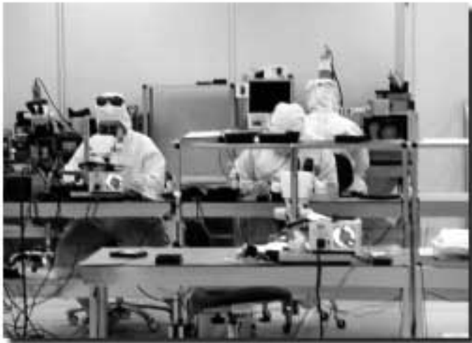
Salle blanche de montage des têtes optiques chez Quinta. Les opératrices et opérateurs utilisent un microscope pour l'assemblage.
